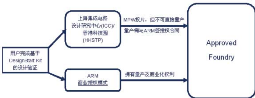
图二 ARM DesignStart 计划中国下载用户的流片途径
