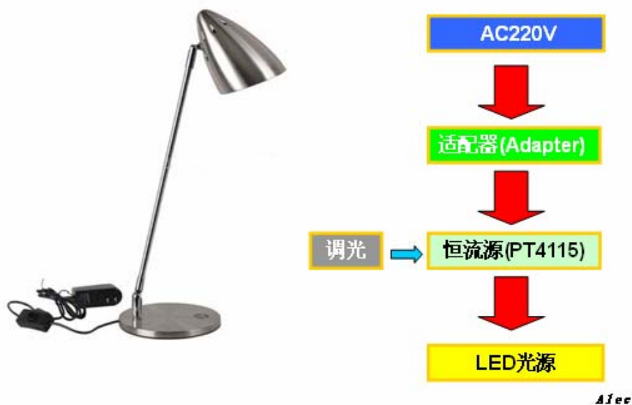
图 1 LED 台灯实物和其工作原理图
